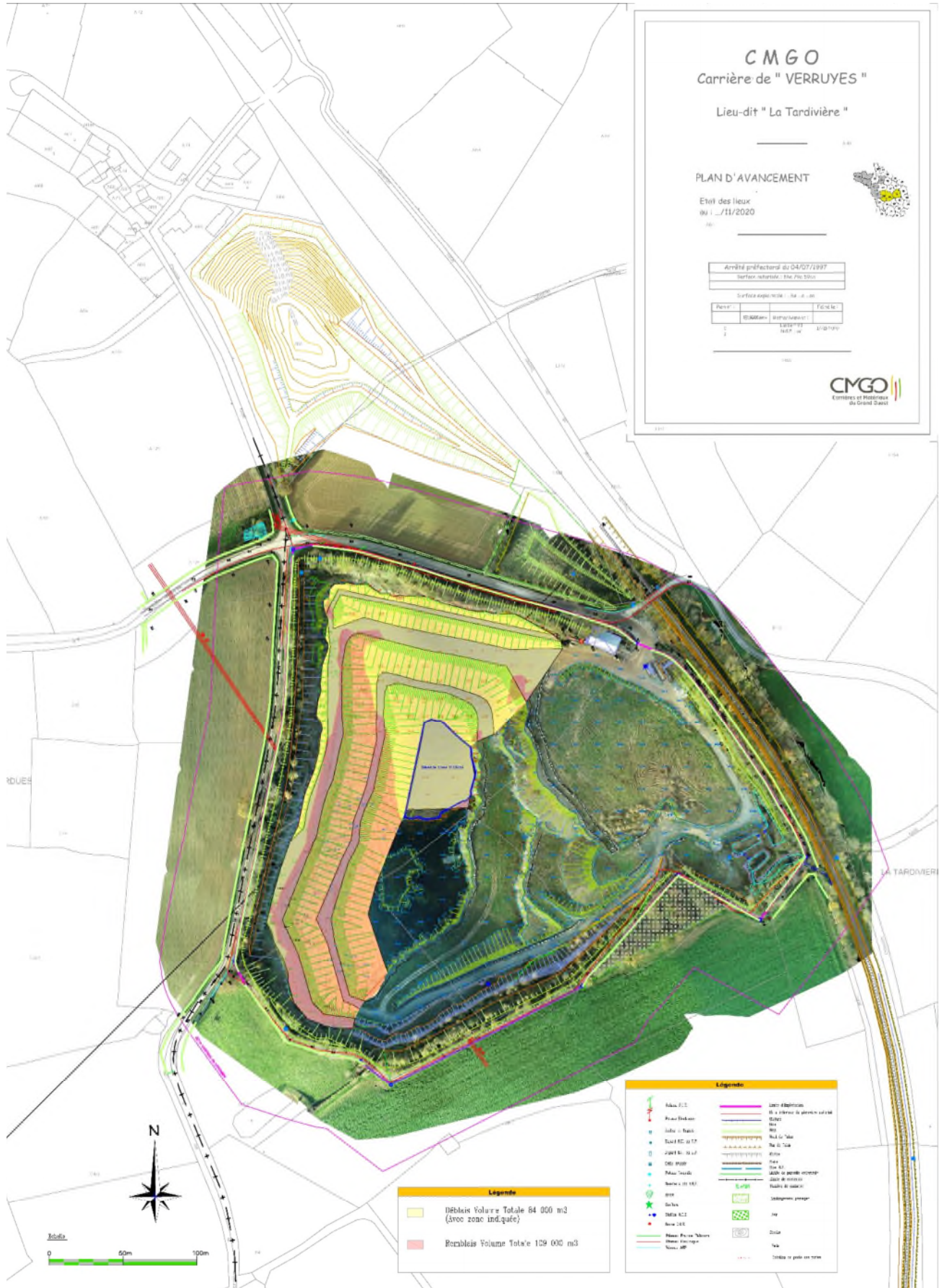
Figure 9 : Plan géométrique de l'avancement de la remise en état – Novembre 2020
